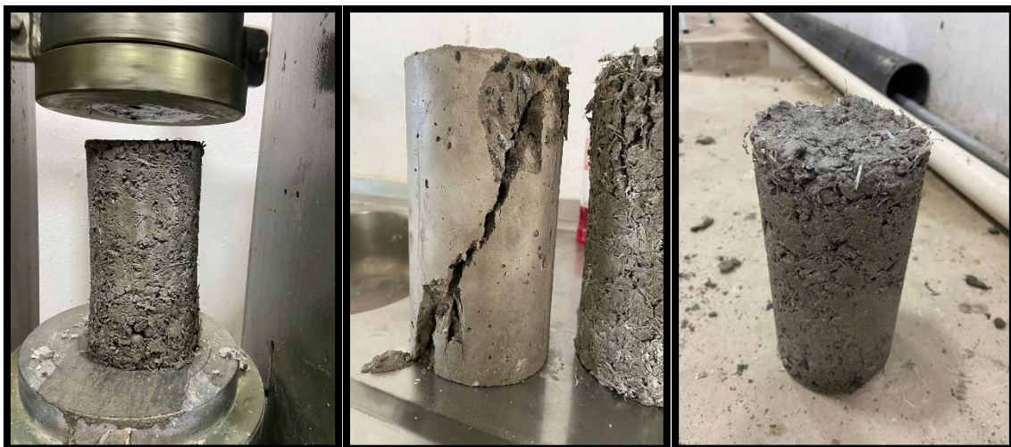
Figura 3 – Corpos de prova moldados e rompidos em prensa hidráulica;
