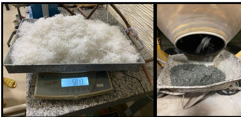
Figura 1 – Pesagem de copos triturados a esquerda e betoneira com mistura a direita
