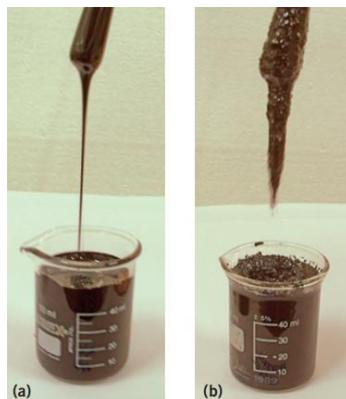
Figura 3: Exemplo de maior consistência do asfalto-borracha no momento da usinagem.
