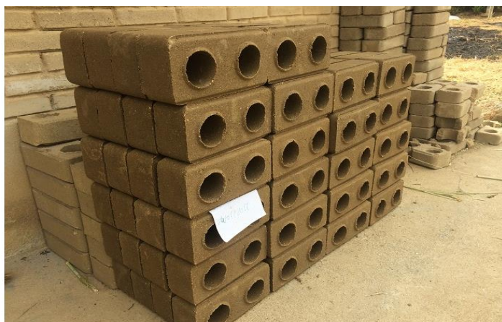
Figura 6: Tijolo solo-cimento já finalizado (em secagem).
