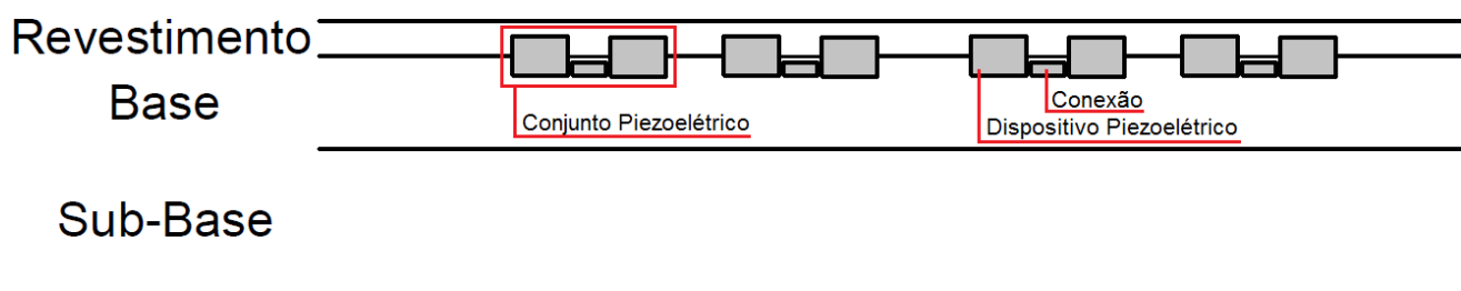
Figura 11 – Representação da Implantação dos Dispositivos de forma Aterrada Fonte: Autores, 2020
