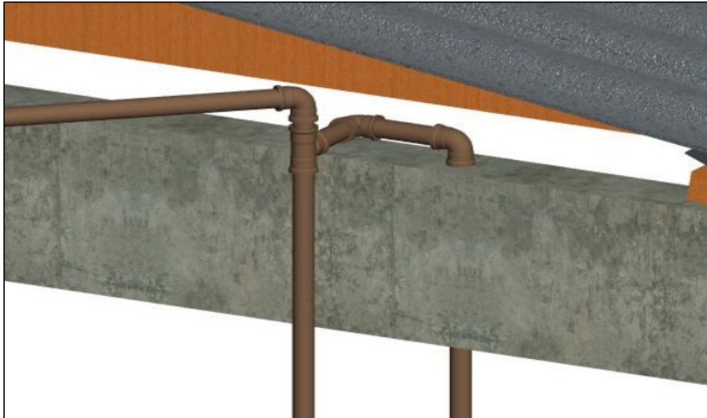
Figura 2 - Incompatibilidade (Estrutural x Hidrossanitário)
