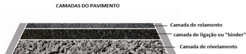
Figura 3 – Camadas do Pavimento
