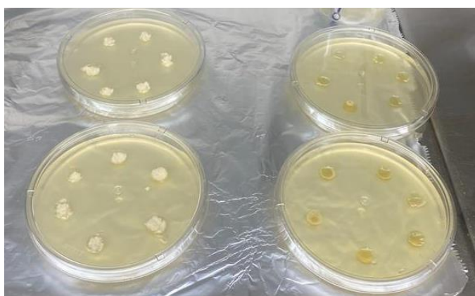
Figura 16: Técnica da difusão em poços em ágar com o extrato seco e diluído.
