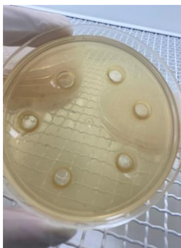
Figura 18: A não formação de halo de inibição do Extrato de própolis seco e diluído em placa de Petri com meio de cultura Ágar Sabouraud, diluído com C. albicans – Lab Elite em solução salina por 24h.
